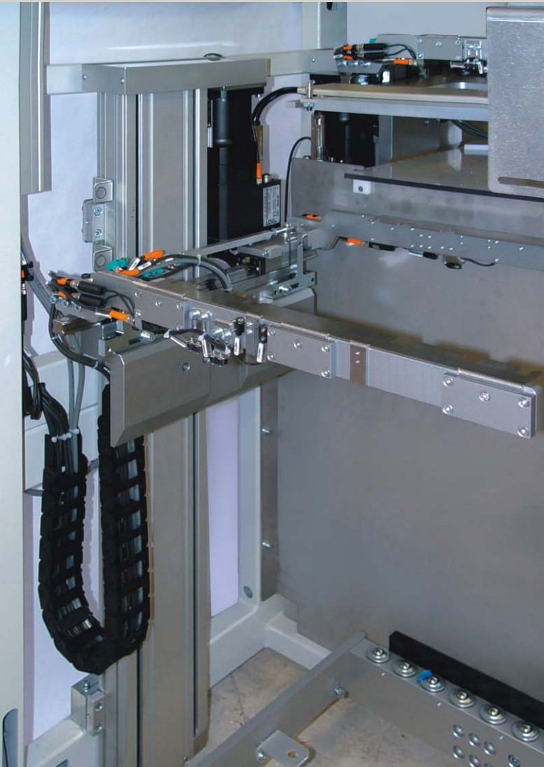
■ Positionieren einer Hubgabel Direct positioning of a lifting fork
