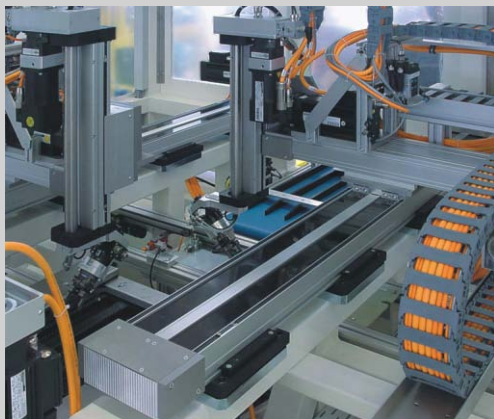
■ Applikationen mit Schwenkgreifer Applications with rotational gripper
